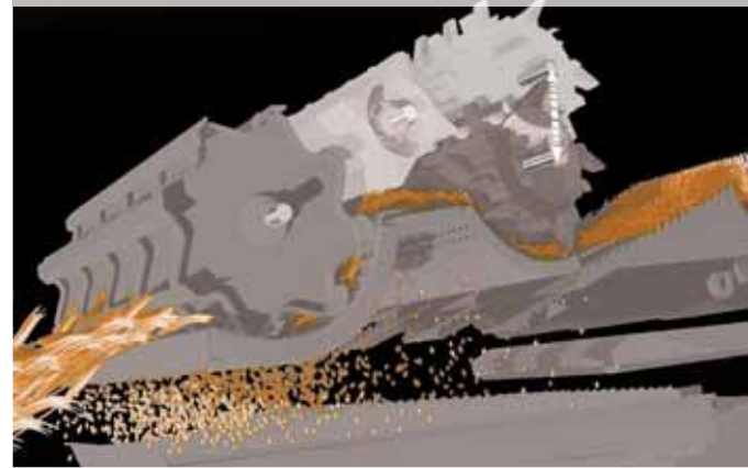
Configuración del sistema de trilla con turbo separador (HTS)
