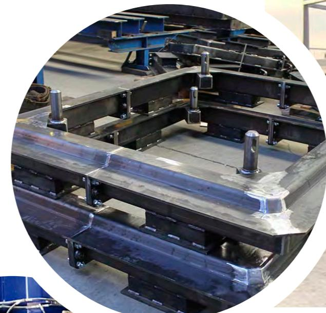
Se coloca la base en el suelo y a continuación mediante puente grúa se posiciona el molde interior y exterior sobre la misma y utilizando grapa hidráulicas para la fijación. Después de levantar la prensa superior se coloca la armadura.
