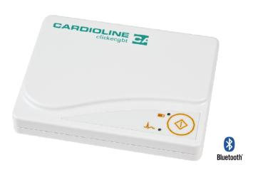
**click**ecg**BT** es una unidad de adquisición de la señal electrocardiográfica capaz de procesar simultáneamente las 12 derivaciones estándar y transmitirlas en tiempo real a un ordenador a través de una conexión inalámbrica tipo bluetooth.
