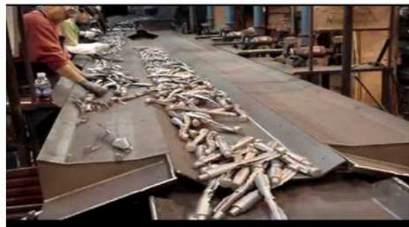
Transportadores de frecuencia natural en una línea de desmazarotado
