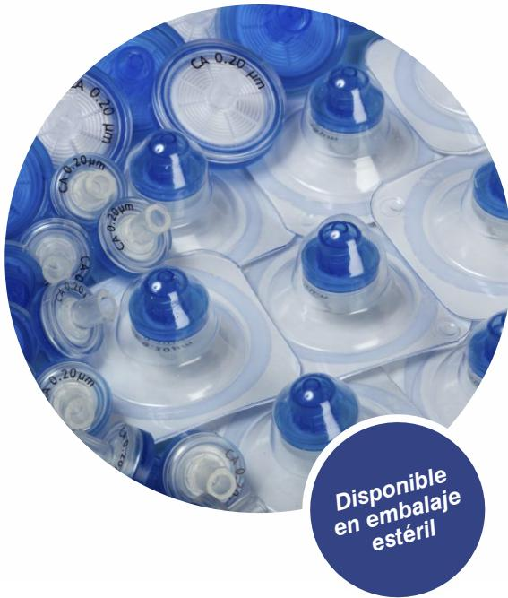
Son muy utilizadas en los laboratorios de análisis de aguas. La porosidad 0,22 mm es muy solicitada para las filtraciones estériles de soluciones acuosas. En tanto que la membrana de 0,45 mm es muy requerida en la reducción de partículas y microorganismos presentes en el fluido.
