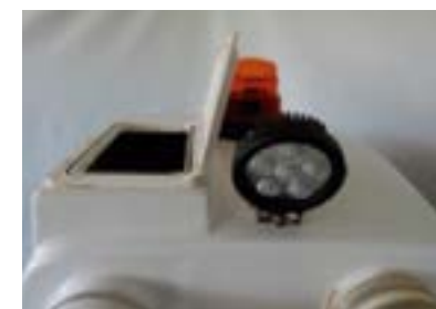
Escotilla para residuos voluminosos que no pueden ser aspirados. Estos están dentro del contenedor por lo tanto no están a la vista y para evitar los olores está sellado y un desodorante se pulveriza en el interior
