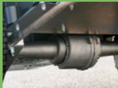
Eje con diferencial y electrofreno. Freno de estacionamiento automático
