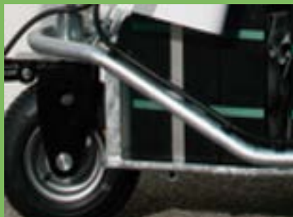
Chasis galvanizado. Resistente a los golpes.
