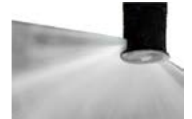
pulverizador (Agua pulverizada para quitar el polvo en la parte inferior del recipiente)
