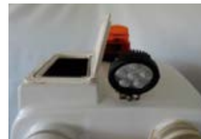
Llum de treball amb LED, orientable, permet el treball de nit i llum intermitent, col·locat en el punt més alt de la coberta superior, 360°
