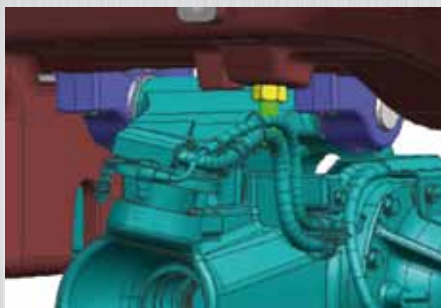
■ Gestión automática de la doble tracción con sensor angular de giro para un menor radio de giro.
