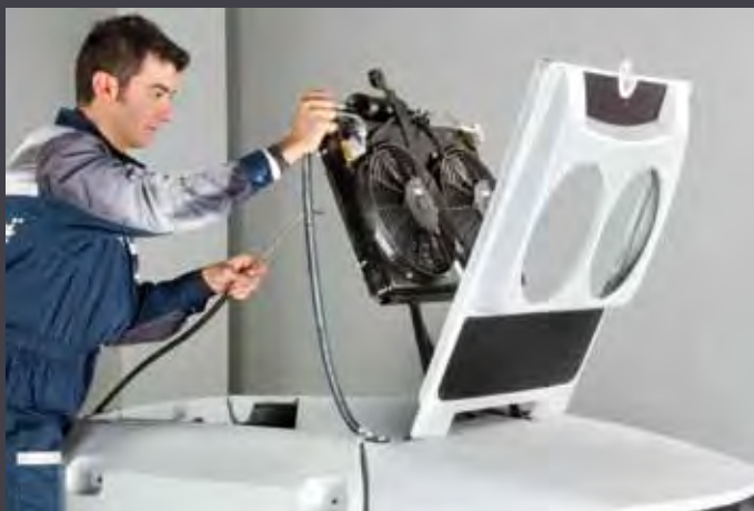
■ La nueva tapa del condensador sobredimensionado del aire acondicionado garantiza elevadas prestaciones y una reducción del tiempo necesario para limpiar los radiadores.
