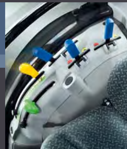
■ En la consola lateral están los distribuidores y el mando del elevador con control mecánico.
