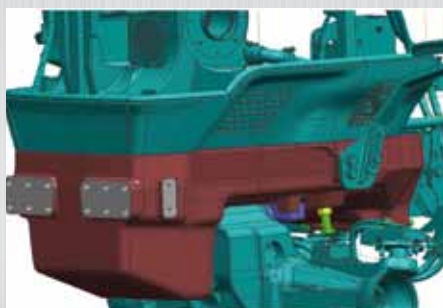
■ Mayor ángulo de giro gracias al nuevo diseño del soporte delantero y al capó más compacto.
