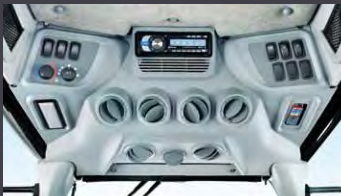
■ Temperatura ideal en la cabina gracias a los aireadores orientables.
