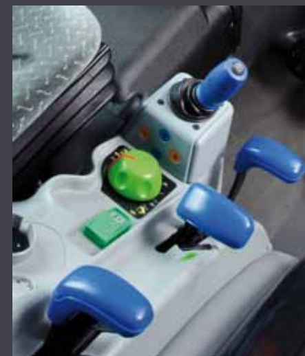
■ Para ampliar las prestaciones y mejorar la comodidad, los RF-RS-RV pueden equiparse con elevador trasero con control electrónico, mandos electrohidráulicos para las principales funciones y palanca cruzada para los distribuidores auxiliares.
