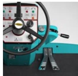
La Xtrema posee un sistema de tracción muy potente y una velocidad máxima de 9 km/h. Esto se controla a través de un doble pedal (para marcha adelante y atrás).
