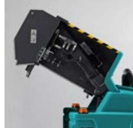
El contenedor de residuos con sistema de descarga multi-nivel está equipado con una puerta controlada hidráulicamente. El depósito está localizado en la parte trasera de la máquina y posee una capacidad de 150l, puede elevarse hidráulicamente a una altura máxima de 1350mm.
