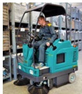
Para una seguridad y confort máximos para el operador, la Xtrema puede ser equipada con una variedad de accesorios: kit de iluminación completo, señal acústica de marcha atrás, techo de protección, parabrisas en policarbonato, faros giratorios (estándar en la UE), filtro de cartuchos de categoría M.
