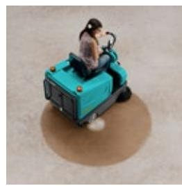
La barredora compacta Tigra tiene un radio de giro reducido (950mm), lo que permite la limpieza de espacios estrechos de difícil acceso.
