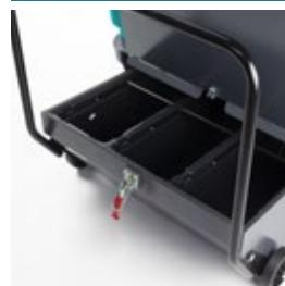
El depósito de 85L es uno de los principales puntos fuertes de la RIDER 1201, permitiendo a la barredora trabajar más tiempo antes de tener que parar para vaciar el depósito. Los cajones reductores opcionales facilitan el proceso de vaciado.
