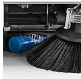
El sistema para levantar el flap se activa desde la posición del conductor y permite que el cepillo principal recoja los residuos más voluminosos.
