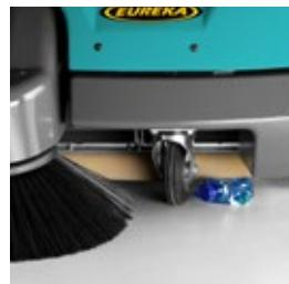
El flap colocado en la parte delantera de la máquina puede ser levantado cuando se recogen residuos más voluminosos.
