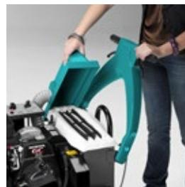
El polvo fino se filtra a través de un filtro de bolsa de poliéster, con un grado de filtración del 99,9%. Este filtro tiene una vida útil mucho más larga que un filtro tradicional y puede ser fácilmente limpiado a través del sacudidor mecánico incorporado.
