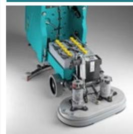
Estas máquinas tienen un chasis de acero de serie. Éste está protegido mediante diferentes fases de tratado usando fosfato de zinc, cataforesis y una pintura termofijada. En las versiones Chrome® del chasis, la boquilla y los componentes mecánicos son de acero inoxidable, lo que otorga una mayor resistencia al trabajar en entornos altamente corrosivos.
