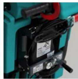
El cargador de batería integrado es la manera ideal de cargar rápidamente la batería. Dependiendo del tipo de batería instalada, la máquina también puede cargarse en espacios con poca ventilación.
