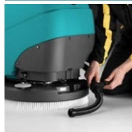
El acceso completo a los tanques hace que el mantenimiento después del uso sea sencillo. El tanque de recuperación puede vaciarse rápidamente gracias a la tubería de aguas sucias, la cual incorpora una válvula, y el filtro de solución es fácil de revisar y limpiar.
