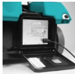
Dos baterías de 12V proporcionan 2 horas y 10 minutos de uso continuo con cada ciclo de recarga. El cargador incorporado está protegido en una carcasa de acero y es de fácil acceso.
