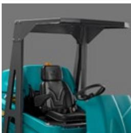
El tejadillo de protección reforzado opcional está hecho de acero de espesor grueso para proteger al operador y la máquina de posibles impactos y estrés.
