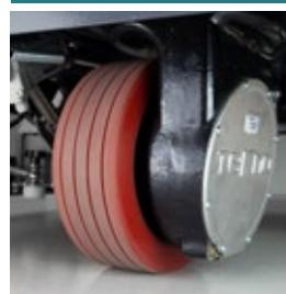
Potente y fiable, el motor de tracción está instalado verticalmente en la parte frontal de la máquina. La rueda frontal es accionada a través de una caja de engranajes que se encuentra lubricada y sellada para protegerla contra impactos, suciedad y humedad.
