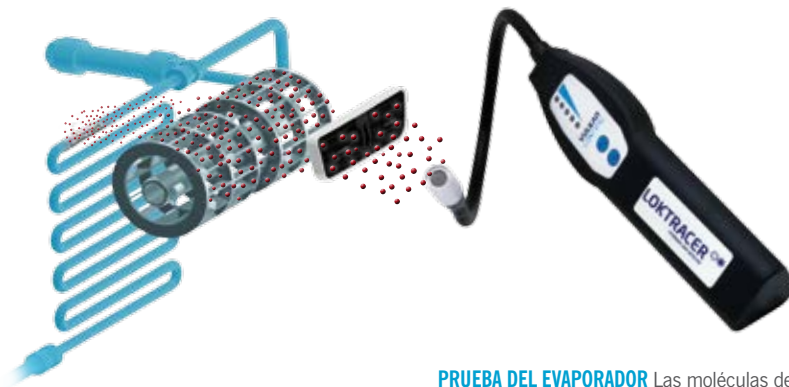
PRUEBA DEL EVAPORADOR Las moléculas de hidrógeno se escapan por la fuga en el evaporador y entran en el habitáculo a través de las ranuras de ventilación.
