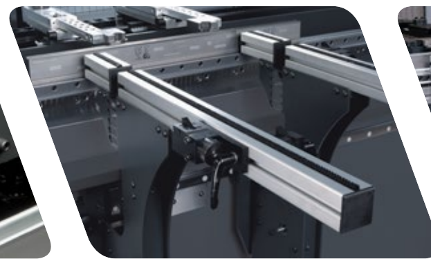
Brazo soporte desplazable ajustable en altura
