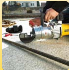
1 Soltar la abrazadera de fijación del cabezal cortador.
