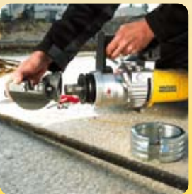
3 Sustituir el cabezal cortador con el cabezal doblador.
