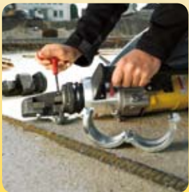
2 Desmontar el bloque de corte del pistón de corte soltando los tornillos.
