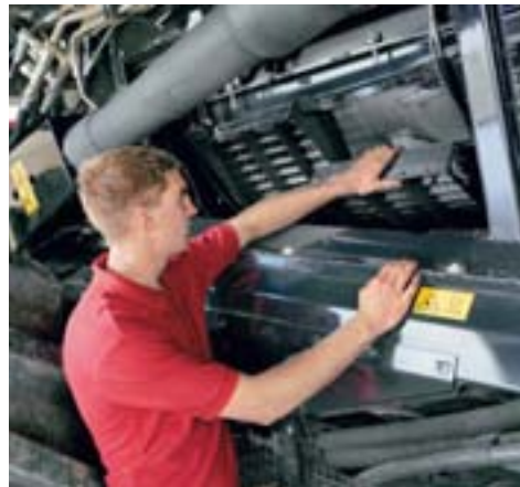
▲ Facilidad de acceso a los cóncavos y el rotor. Ahora es más sencillo limpiar y cambiar los cóncavos y las barras desgranadoras del rotor.
