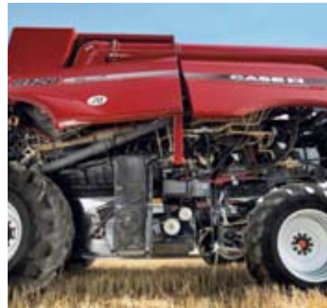
▲ Grandes paneles laterales. Paneles compuestos que se abren sin dificultad para dejar a la vista el interior de la cosechadora.
