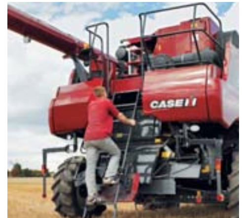
▲ Espaciosa placa del motor y el sistema de refrigeración. La robusta escalerilla facilita el acceso a la placa desde la parte trasera de la cosechadora.
