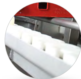
Cadena sintética para el transporte de cajas
