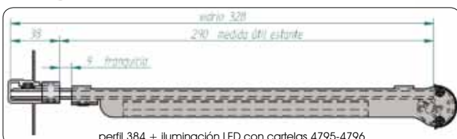
perfil 384 + iluminación LED con cartelas 4795-4796
