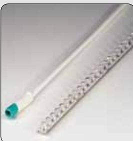
4765/009 LED CON MINI-CONEXIÓN 24 V, 6400°K 126 diodos 6,9 W por tira Largo tira 922 mm Cable 40 cm y mini-conector incluidos Cortable cada 7 Leds
