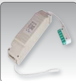
4769/000 CONVERTIDOR CON 6 SALIDAS 24 V CON MINI- CONEXIONES 50 W = 6 LEDs 230 V (50-60Hz) a 24 V Medidas: 210x51x36 mm (fondo 36 mm)
