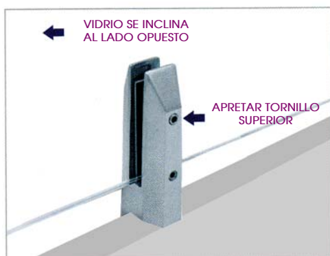
SISTEMA DE MONTAJE Y AJUSTE PARA SOPORTE BARANDILLA
