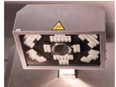
Cámara de alta resolución para fotografías de superficie completa
