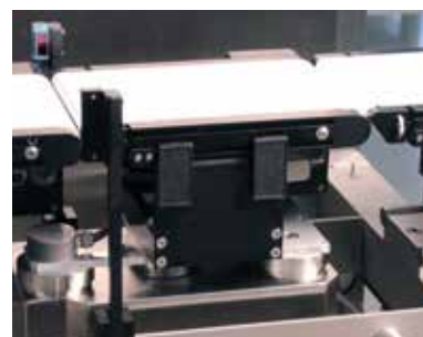
Pesaje de alta precisión con la célula de pesaje EDK de Wipotec
