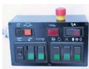
Todas las funciones de la barredora se controlan fácilmente desde un panel de mando situado en la cabina a fácil abasto del conductor. Desde éste se puede incluso regular la presión y velocidad de los cepillos y cinta transportadora, además de puesta en marcha, bomba de agua, rotativo, etc.
