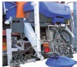
Hay dos maneras de rociar con salmuero: Utilizando el plato del esparcido con puntos adicionales de inyección de hasta 8 metros de ancho, o
