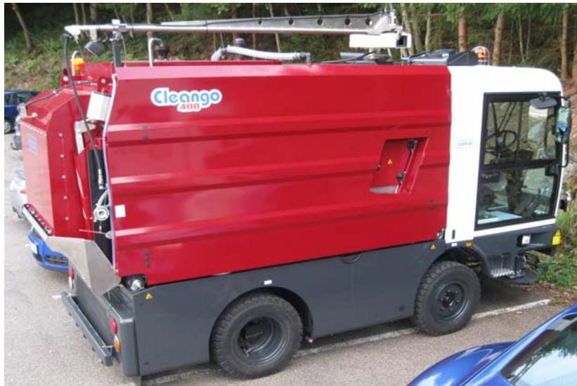
Este modelo nace como consecuencia de las necesidades del sur de Europa de minimizar el consumo de agua y de maximizar los rendimientos del barrido mixto. A la ya existente barredora modelo Cleango 500 se le han incorporado una serie de depósitos adicionales de agua (2.300 Litros) que junto con una bomba adicional de agua, una pétiga de baldeo superior y una barra de baldeo delantera consiguen tener dos máquinas en una.
