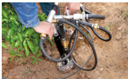
Inyección de hidrogel con el Inyector MTM Biolift
