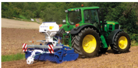
VOGT Geo Tiller, una cultivadora rotativa modificada de AMAZONE, equipada con una unidad dosificadora para gránulos secos
