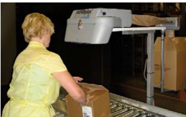
Máquina Shooter modificada, montada sobre un brazo giratorio que acerca el material al operador.
