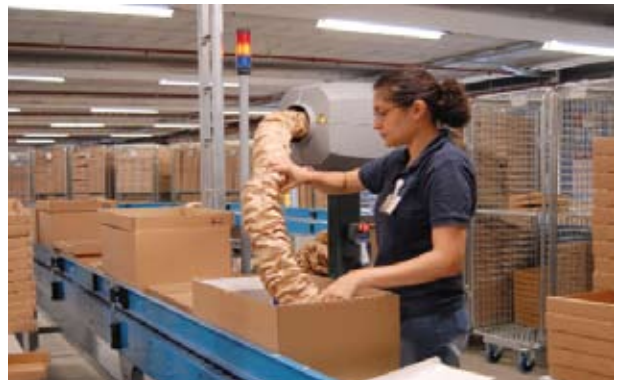
Embalaje en línea con máquina Chevron.
