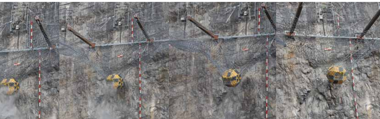
Imagen izquierda: los cables de soporte son conducidos prácticamente sin rozamiento a través de las poleas.
