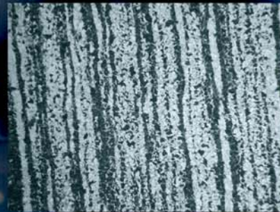
Microestructura de pieza recocida sin forjar.
