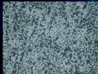
Microestructura de pieza recocida y cementada forjada.
