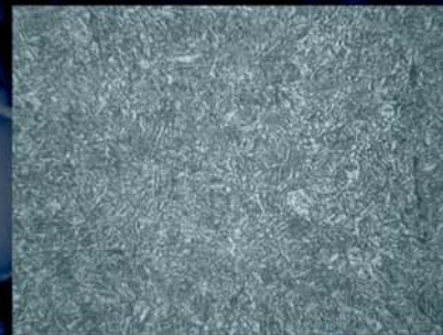
Microestructura de pieza forjada y recocida.
