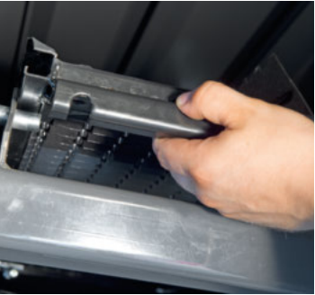
Extracción de las cribas
