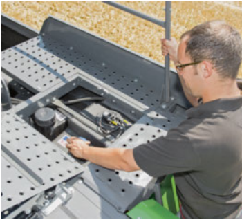
Llenado de combustible
