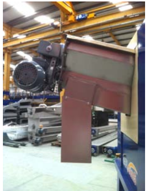
CANAL CON TRANSPORTADOR SINFÍN PARA SEPARACIÓN Y EVACUACIÓN DE PIEDRAS
