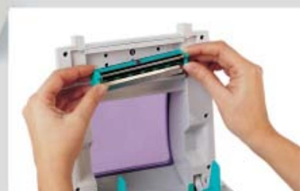
▼ Cambio de cabezal sin herramientas
