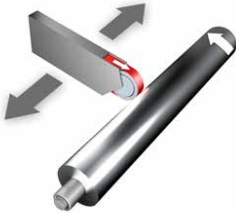
Lijado redondo de émbolos y cilindros p.ej. entre centros
