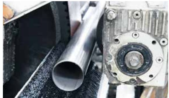
Lijado "Centerless" de tubos y barras.
