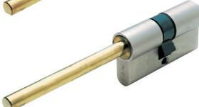
Cilindro F5 DOBLE PERFIL con **VARILLA Ø 8 x 75**, preparado para pomo interior + cuerpo cilindro F5 de 30 mm interno, de 30 mm interno, llave grande externa 5 pistones. Leva DIN 30°.
