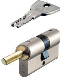
Cilindro R90 con SISTEMA PATENTADO, doble perfil europeo niquelado, **PREPARADO PARA POMO**, cifrado con 14 pistones, llave plana de alpaca. Perfil de llave protegido y registrado. **RESISTENTE AL BUMPING**. Protección antitaladro en cuerpo y rotor. Pistones de cifrado de acero inox. Barra antiextracción. Varilla D 8x16 mm. Leva DIN 30°. **5 llaves. TARJETA DE PROPIEDAD.** Tornillo de fijación. (Código llave TALLADA 80RCSKOGO).
