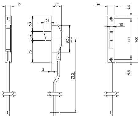
Desviadores **TRIPLE CIERRE, LATERAL** para montaje con varillas internas,
