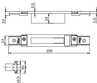
Cerradero de sección 30 x 5,5 mm cerrado **REGULABLE PARA CERRADURA SOLO PALANCAS Y DESVIADORES MULTIBLINDO** 78 - 96 - 98 550 - 551 - 556 - 70 - 71 - 730 - 731 - 736 - 737 y para series 78\* y 79\*. Frente plano **205 x 30** mm acero barnizado NEGRO.
