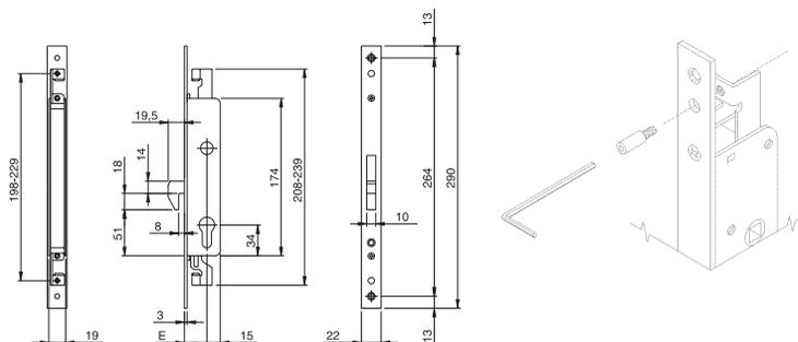
Cerradura de embutir para perfil, 3 PUNTOS DE CIERRE, con cilindro perfil europeo. Enganche de varillas con tornillo
