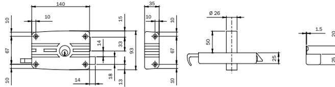
Cerradura de sobreponer CINCADA para hierro sin solape. 4 orificios de fijación. Cilindro interno y cilindro fijo Ø 26x50 mm externo. Resbalón reversible separado con tirador interno y llave por el exterior. PALANCA de 3 vueltas de llave. 3 LLAVES. Cerradero. Tornillos de fijación. (Código llave en bruto 020259).
