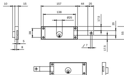
Pareja de cerraduras para persiana a códigos iguales. Instalación horizontal **LATERAL DERECHAS + IZQUIERDAS**. Caja barnizada. PALANCA CINCADE de una vuelta de 25 mm con ORIFICIO PARA ENGANCHE VARILLAS  $\varnothing$  7 mm. Cilindro redondo  $\varnothing$  25 mm que sobresale de la caja de la cerradura 10 mm. 2 LLAVES DE PERFIL CENTRAL (Código llave en bruto 020409).
