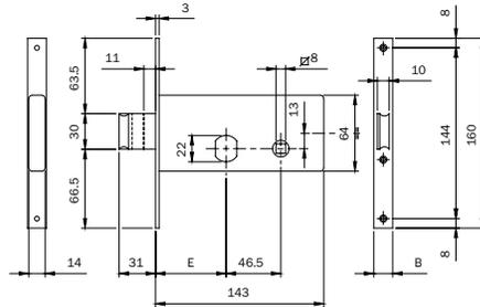
Cerradura CINCADA de embutir para zócalo. Funcionamiento con **CILINDRO REDONDO PLANO Ø 22 mm.**
