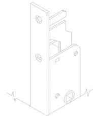
Cerradura de embutir para perfil, 3 PUNTOS DE CIERRE, con cilindro perfil europeo.
