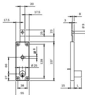
Cerradura para persiana. Instalación **VERTICAL**. Caja barnizada. PALANCA CINCADE de una vuelta de 25 mm con manilla y PERNIO PARA ENGANCHE CON VARILLAS  $\varnothing$  9x8 mm. Cuadro manilla 8 mm, desbloqueo de manilla con cilindro redondo  $\varnothing$  25 mm desde el exterior y con tirador desde el interior. El cilindro sobresale de la caja de la cerradura. 2 LLAVES DE PERFIL ESTÁNDAR (Código llave en bruto 020259).
