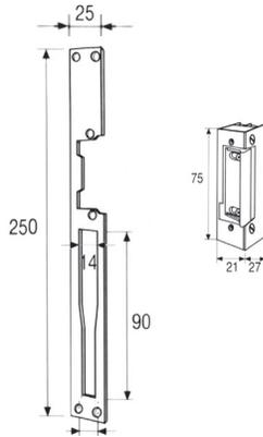
Cerradero eléctrico **REVERSIBLE SIMÉTRICO REGULABLE** con frente plano de **25 x 250 x 03** mm.
