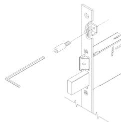
Electrocerradura para zócalo, funcionamiento con cilindro de perfil europeo. **12V AC/DC.**
