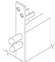
Cerradura de embutir de doble paletón para zócalo. TRIPLE CIERRE. Enganche varillas con ranura.
