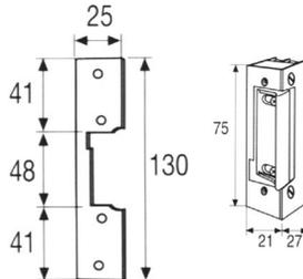
Cerradero eléctrico **REVERSIBLE SIMÉTRICO REGULABLE** con frente plano de **25 x 130 x 03** mm.
