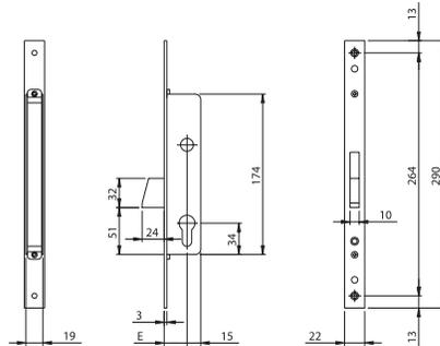
Cerradura de embutir para perfil, 1 PUNTO DE CIERRE, con cilindro perfil europeo. Frente **290 x 22 x 3** mm. de acero INOX. PALANCA rotante de 24 mm.
