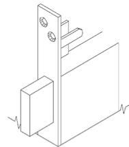
Cerradura de embutir de doble paletón para zócalo. TRIPLE CIERRE. Enganche varillas con ranura. 3 LLAVES de **79 mm**. Frente **240 x 25 x 3 mm** en acero cincado. Altura caja 82 mm. 4 vueltas de llave de 9 mm. **RESBALÓN REVERSIBLE**. Recogida del resbalón con llave o cuadro manilla 8 mm. 2 escudos de nylon para cilindro, tornillos de fijación, **CONFECCION CAJA INDIVIDUAL**. (Código llave en bruto 990800).
