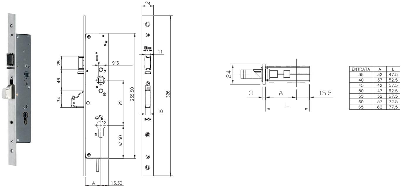
Multiblando Easy Exit con función antipánico accionada mediante barra horizontal.
