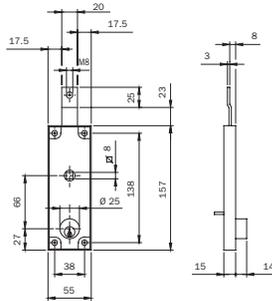
Cerradura para persiana. Instalación **VERTICAL**. Caja barnizada. PALANCA CINCADE de una vuelta de 25 mm. con manilla y ORIFICIO ROSCADO M8 PERNIO PARA ENGANCHE CON VARILLAS. Cuadro manilla 8 mm, desbloqueo de manilla con cilindro redondo  $\varnothing$  25 mm desde el exterior y con tirador desde el interior. El cilindro sobresale de la caja de la cerradura 14 mm. 2 LLAVES DE PERFIL ESTÁNDAR (Código llave en bruto 020259).
