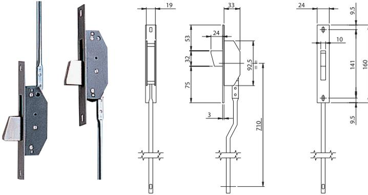
Desviadores para TRIPLE CIERRE, LATERAL. con varillas interiores para cerraduras de enganche varillas con ranura. Frente **160 x 24 x 3** mm en acero INOX.
