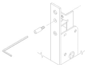
Cerradura de embutir para perfil, 3 PUNTOS DE CIERRE, con cilindro perfil europeo. Enganche de varillas con tornillo
