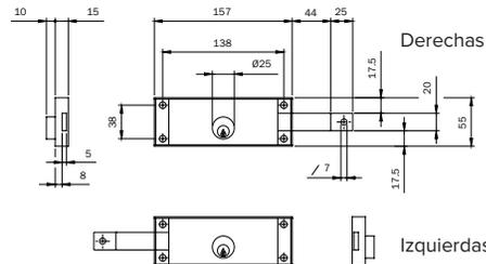
Cerradura para persiana. Instalación horizontal **LATERAL IZQUIERDAS**. Caja barnizada. PALANCA CINCADE de una vuelta de 25 mm con ORIFICIO PARA ENGANCHE VARILLAS  $\varnothing$  7 mm. Cilindro redondo  $\varnothing$  25 mm que sobresale de la caja de la cerradura 10 mm. 2 LLAVES DE PERFIL CENTRAL (Código llave en bruto 020409).
