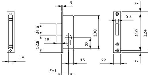
Cerradura para embutir para **PUERTA DE VIDRIO**, funcionamiento con cilindro de perfil europeo.
