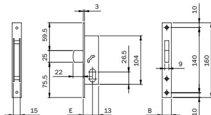
Cerradura para embutir para perfil estrecho. Funcionamiento con cilindro oval.
