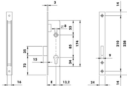
Cerradura para embutir en perfil, funcionamiento con cilindro de perfil europeo.
