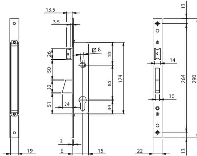
Cerradura de embutir para perfil, 1 PUNTO DE CIERRE, con cilindro perfil europeo. Frente **290 x 22 x 3 mm**. de acero INOX. PALANCA rotante de 24 mm. **RESBALÓN REVERSIBLE Y REGULABLE** de 10 a 15 mm. Accionamiento de resbalón mediante llave o CUADRO MANILLA de 8 mm. 2 juegos de suplementos de nylon, 2 escudos de nylon para cilindro, tornillos de fijación, instrucciones de montaje
