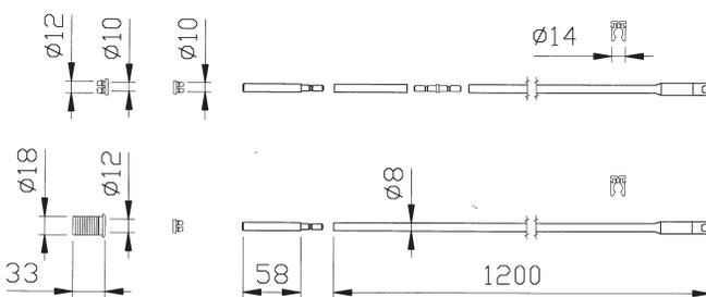
Juego varillas rectas interiores. Tubo cincado Ø 8 mm para enganche con tornillo M4. 2 puntales Ø 8 mm. Cerradero para puntal de nylon Ø 8 mm. 2 boquillas antirruido para varillas de nylon. 1 empalme para varillas. 2 guías de varillas de nylon. 1 casquillo para suelo con tapón guarda polvo Ø 12 mm. Para cerraduras con varilla de enganche por tornillo series 7275\* - 7295\* - 782\* - 783\* - 963\*
