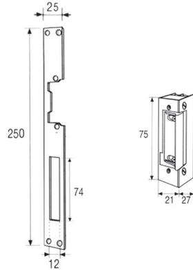
Cerradero eléctrico **REVERSIBLE SIMÉTRICO REGULABLE** con frente plano de **25 x 250 x 03** mm.
