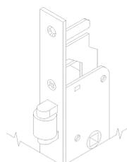
Cerradura de embutir para perfil, 3 PUNTOS DE CIERRE, con cilindro perfil europeo.
