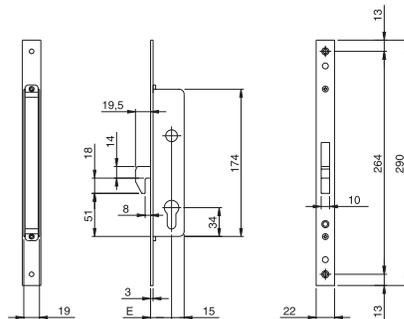
Cerradura de embutir para perfil, 1 PUNTO DE CIERRE, con cilindro perfil europeo. Frente **290 x 22 x 3** mm. de acero INOX. GANCHO rotante de 18 mm **CON LUZ DE 8** mm.
