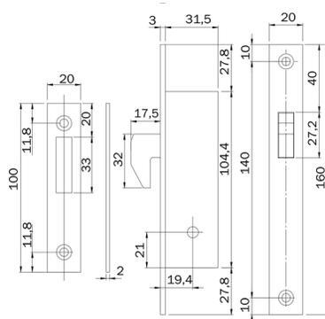
Cerradura para embutir para perfil estrecho. Entre ejes 20 mm. **GANCHO BASCULANTE.**
