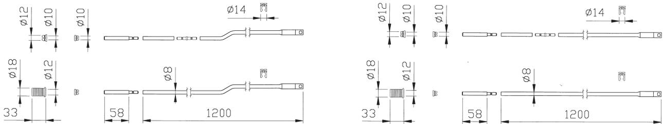
Juego varillas interiores. Tubo cincado  $\varnothing$  8 mm para enganche con tornillo M4.
