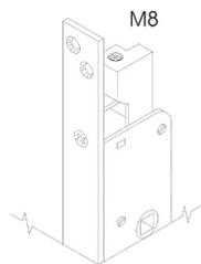
Cerradura de embutir para **PERSIANAS**, TRES PUNTOS DE CIERRE, cilindro perfil europeo. Rosca para empalme varilla M8 premontada. Salida varillas 15 mm. Frente **290 x 24 x 3** mm. GANCHO ROTANTE de 18 mm **CON LUZ DE 6,5** mm. Accionamiento puntos de cierre mediante cuadro manilla 8 mm, bloqueo manilla con cilindro. Escudo.
