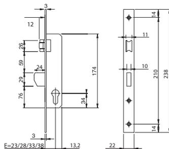
Cerradura para embutir en perfil, funcionamiento con cilindro de perfil europeo.
