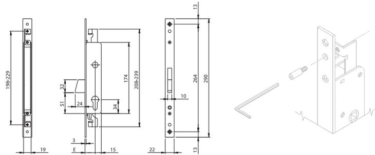
Cerradura de embutir para perfil, 3 PUNTOS DE CIERRE, con cilindro perfil europeo. Enganche de varillas con tornillo
