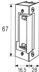
Caja de mecanismo **REVERSIBLE**. Regulable horizontalmente. **12V AC**.
