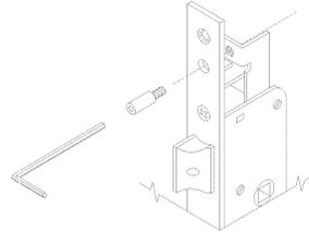
Cerradura de embutir para perfil, 3 PUNTOS DE CIERRE, con cilindro perfil europeo. Enganche de varillas con tornillo
