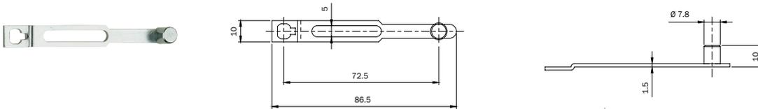
Juego de pletinas de enganche con tornillo M4 para conexión de la cerradura, o del desviador, a las varillas exteriores. De acero cincado.
