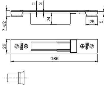
Cerradero para perfiles puerta cerrado **REGULABLE PARA CERRADURA SOLO PALANCAS Y DESVIADORES MULTIBLINDO** series 96\* - 98\* - 550 - 551 - 556 - 70\* - 71\* 730 - 731 - 736 - 737 y para series 78\* y 79\*.
