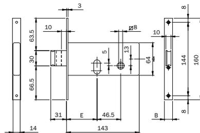
Cerradura CINCADA de embutir para zócalo con cilindro oval. CIERRE LATERAL. CAJA H 64 cincada.
