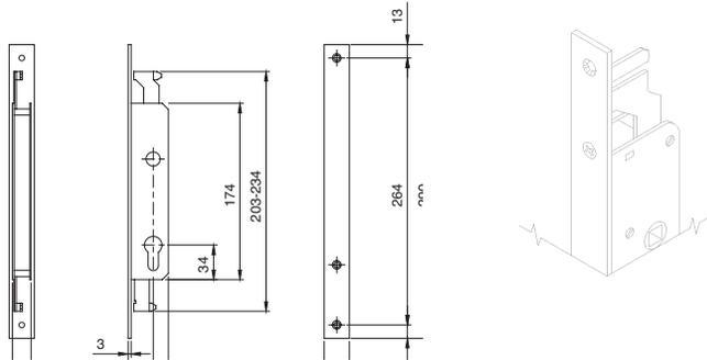
Cerradura de embutir para perfil, 2 PUNTOS DE CIERRE **ALTO / BAJO** con cilindro perfil europeo.
