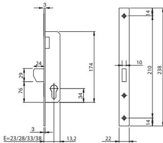
Cerradura para embutir en perfil, funcionamiento con cilindro de perfil europeo.
