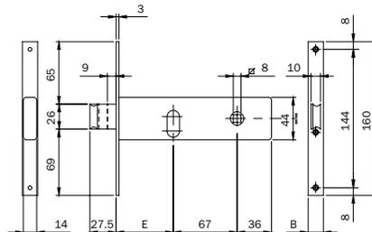
Cerradura CINCADA de embutir para zócalo con cilindro oval. CIERRE LATERAL. CAJA H 44 cincada.
