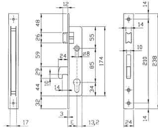
Cerradura para embutir en perfil, funcionamiento con cilindro de perfil europeo.
