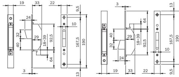
Desviadores TRIPLE CIERRE, LATERAL para montaje con varillas externas,
