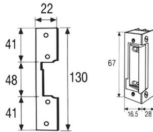
Cerradero eléctrico **REVERSIBLE SIMÉTRICO REGULABLE** con frente plano de **22 x 130 x 03 mm**.
