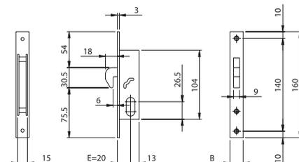
Cerradura para embutir para perfil estrecho. Funcionamiento con cilindro oval. 1 vuelta de llave.
