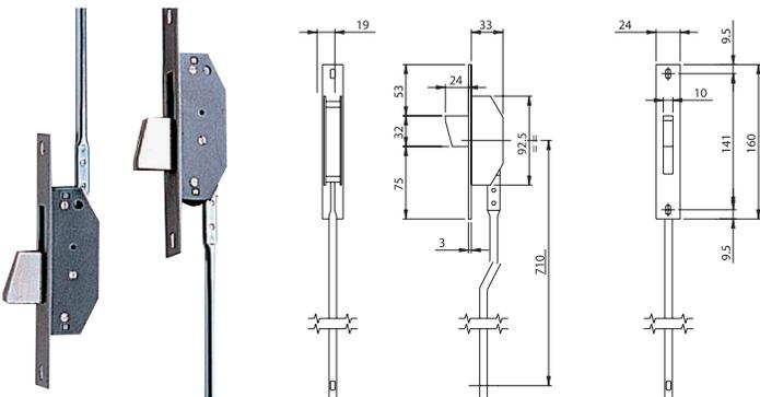
Desviadores para TRIPLE CIERRE, LATERAL. con varillas interiores para cerraduras de enganche varillas con ranura. Frente **160 x 24 x 3** mm en acero CINCADO.
