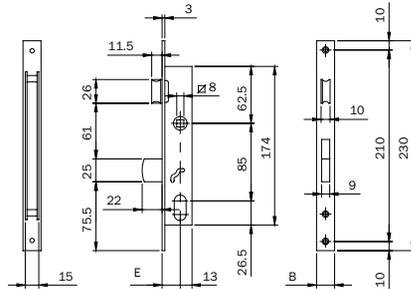
Cerradura para embutir para perfil estrecho. Funcionamiento con cilindro oval.
