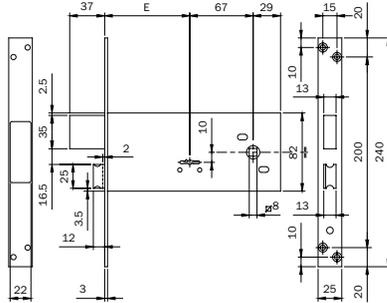
Cerradura de embutir de doble paletón para zócalo. CIERRE LATERAL 3 LLAVES de **79 mm**. Frente **240 x 25 x 3 mm**. en acero cincado. Altura caja 82 mm. 4 vueltas de llave de 9 mm. **RESBALÓN REVERSIBLE**. Recogida del resbalón con llave o cuadro manilla 8 mm. 2 escudos de nylon para cilindro, tornillos de fijación, **CONFECCION CAJA INDIVIDUAL**. (Código llave en bruto 990800).
