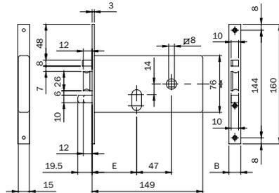
Electrocerradura CINCADA de embutir para zócalo con cilindro oval. **12V AC**.
