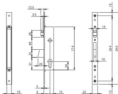
Cerradura de embutir para perfil, 1 PUNTO DE CIERRE, con cilindro perfil europeo. Frente **290 x 22 x 3 mm**. de acero INOX. PALANCA rotante de 24 mm. **RODILLO REGULABLE**. 2 juegos de suplementos de nylon, 2 escudos de nylon para cilindro, tornillos de fijación, instrucciones de montaje
