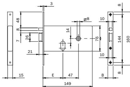
Electrocerradura CINCADA de embutir para zócalo con cilindro oval. **12V AC**.
