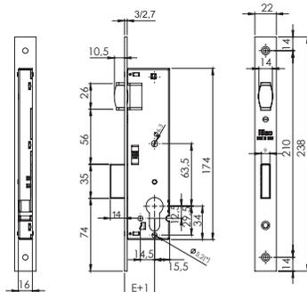
Cerradura para embutir en perfil, con caja cerrada, funcionamiento con cilindro de perfil europeo.
