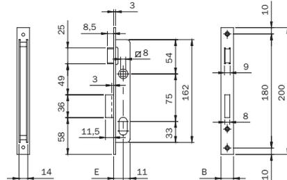
Cerradura para embutir para perfil estrecho. Funcionamiento con cilindro oval.
