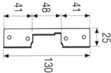
Frente de **25 x 130** mm. Para cerraduras de sólo resbalón. Adaptable a las cajas de mecanismos serie A17\*\*.
