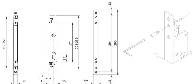
Cerradura de embutir para perfil, 2 PUNTOS DE CIERRE **ALTO - BAJO**, con cilindro perfil europeo.
