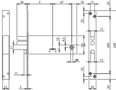
Cerradura de embutir de doble paletón para zócalo. CIERRE LATERAL. 3 LLAVES de **79 mm**.
