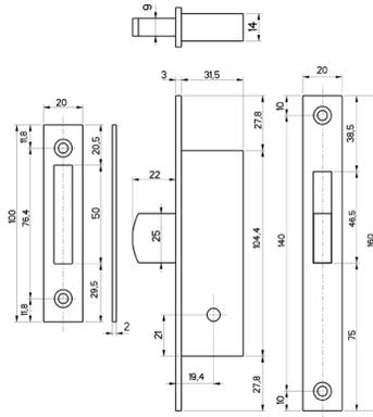
Cerradura para embutir para perfil estrecho. Entre ejes 20 mm. **PALANCA BASCULANTE.**
