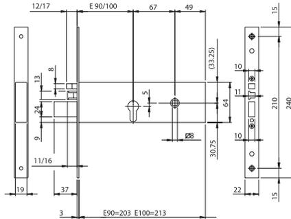
Electrocerradura para zócalo, funcionamiento con cilindro de perfil europeo. **12V AC/DC.**
