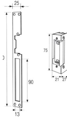
Cerradero eléctrico **REVERSIBLE SIMÉTRICO REGULABLE** con frente plano de **25 x 250 x 03** mm.
