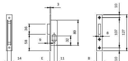
Cerradura para embutir para perfil estrecho. Funcionamiento con cilindro oval.
