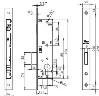
Cerradura para embutir en perfil, con caja cerrada, funcionamiento con cilindro de perfil europeo.
