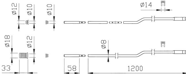
Juego varillas desviadas interiores. Tubo cincado Ø 8 mm para enganche con tornillo M4. 2 puntales Ø 8 mm. Cerradero para puntal de nylon Ø 8 mm. 2 boquillas antirruido para varillas de nylon. 1 empalme para varillas. 2 guías de varillas de nylon. 1 casquillo para suelo con tapón guarda polvo Ø 12 mm. Para cerraduras con varilla de enganche por tornillo series 7275\* - 7295\* - 782\* - 783\* - 963\*
