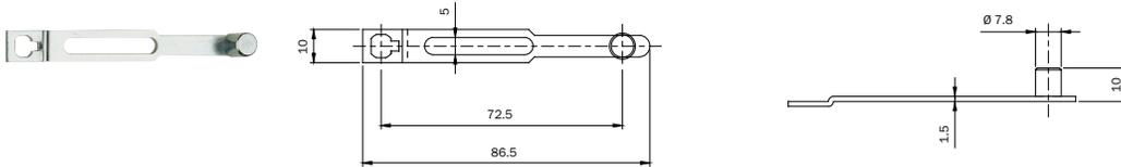
Juego de pletinas para conexión entre cerradura o desviadores con empalmes roscados M4 a las varillas externas. En acero cincado.
