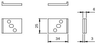
Juego de suplemento de **NYLON** bajo frente para cerradura de embutir con cilindro de perfil europeo y zócalo doble paletón para aluminio.
