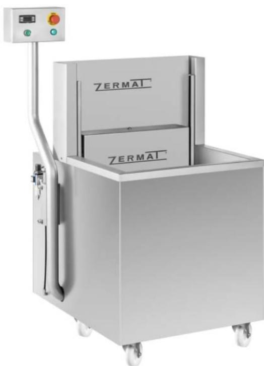
Construcción sólida y extra robusta en acero inox. Programación ajustable de la temperatura del agua. Máquina de operativa sencilla; accionando el pulsador realiza la inmersión automática de los productos en el agua.
