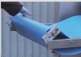
El fácil desmontaje de las bandas sin herramientas, facilita el mantenimiento y la limpieza
