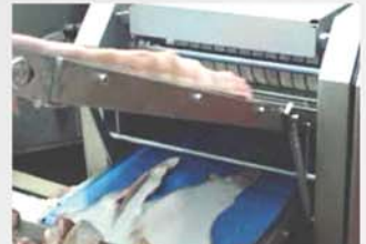
La tercera cinta de salida corteza, opcional, aumenta la versatilidad en cadenas en serie.
