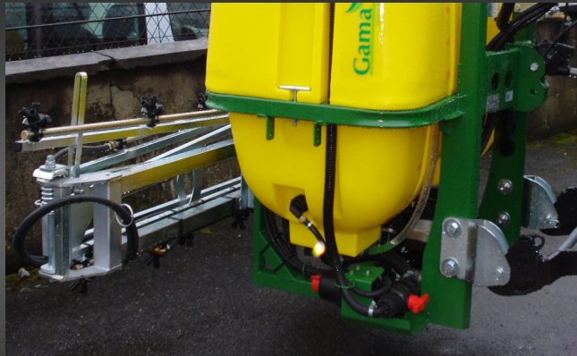
DISEÑO COMPACTO CON VALVULAS Y FILTROS DE FACIL ACCESO
