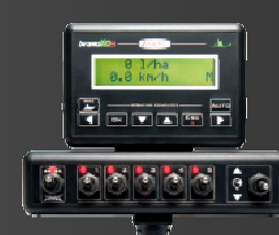
COMPUTADORA 5-7 VIAS CONTROL AUTOMATICO DE LA DOSIFICACION
