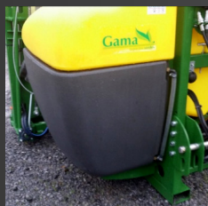
AMPLIO DEPOSITO AUX. LAVA-CIRCUITOS DE 190L
