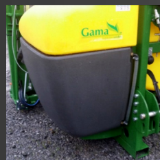
AMPLIO DEPOSITO AUX. LAVA-CIRCUITOS DE 190L
