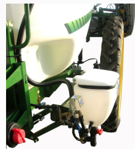
PREMEZCLADOR DE PRODUCTO 40L CON LAVAENVASES Y SISTEMA DE ACERCAMIENTO AL USUARIO. (DE SERIE)
