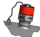
Detalle boquilla G 1" con válvula limitadora de presión (+0,65 bar) (1 : 2)
