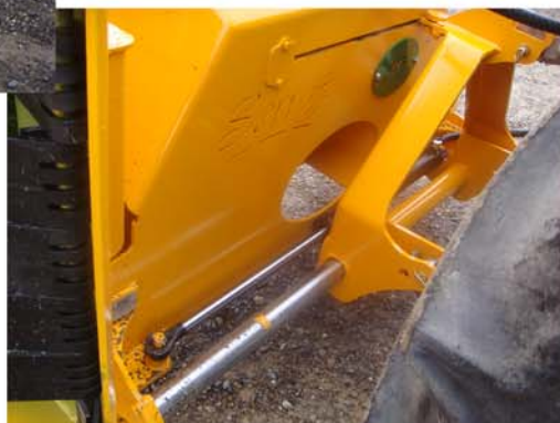
Desplazamiento lateral hidráulico
