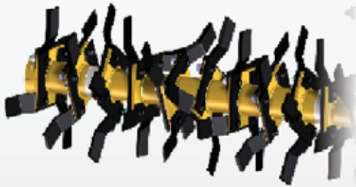
Rotor mit waagerechter Achse, ausgerüstet mit geraden, messerartigen Werkzeugen zur optimalen Zerkleinerung der Böden, die vorher unter sehr harten und trockenen Umständen gehackt worden waren.
